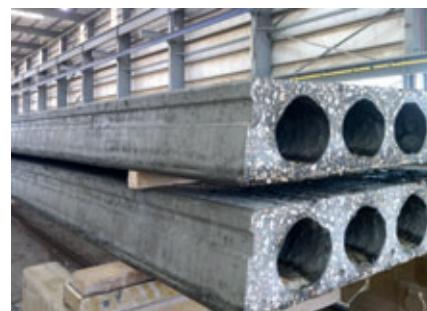
Vista da superfície de alta qualidade dos perfis laterais de uma laje alveolar protendida de 900 mm de largura.
