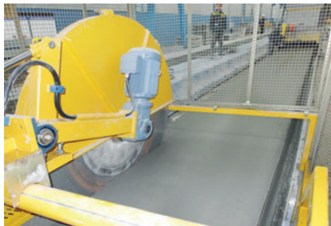
Corte de serra em sentido longitudinal de uma laje alveolar protendida em concreto fresco, com a serra de concreto fresco, da Nordimpianti.
