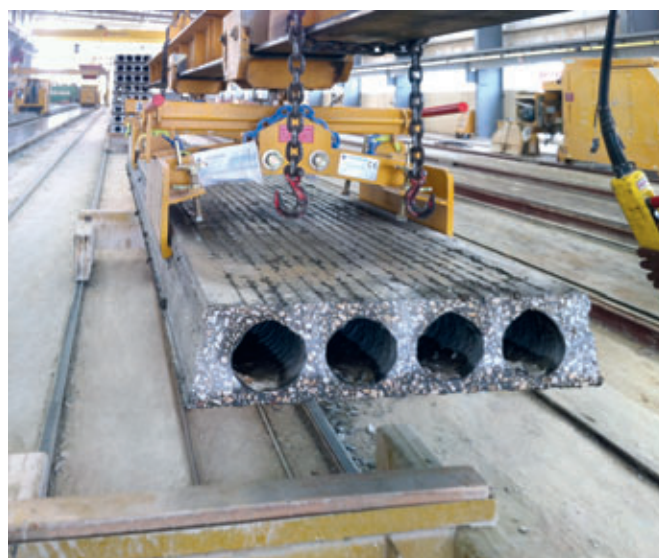
Elevação de uma laje alveolar protendida de 900 mm com os grampos providos para o efeito.
