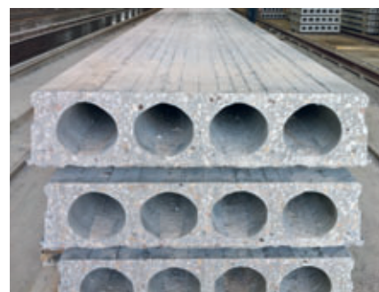
Uma laje alveolar protendida produzida com uma extrusora Nordimpianti, com uma largura de 900 mm.
