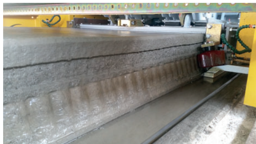
Detalhe da superfície lateral perfilada inovadora, desenvolvida pela Nordimpianti.
